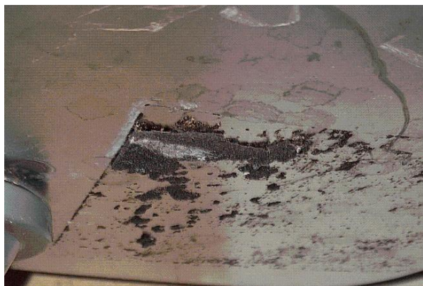
Prélèvement - P041 : RDC / Cuisine - Plaque souple bitumineuse antivibratile- (Présence d'amiante)
