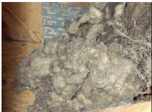
Prélèvement - P004 : 2 eme étage / Comble - Isolant- (Absence d'amiante)
