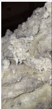
Prélèvement - P039 : 1 er étage / Comble - Isolant- (Absence d'amiante)
