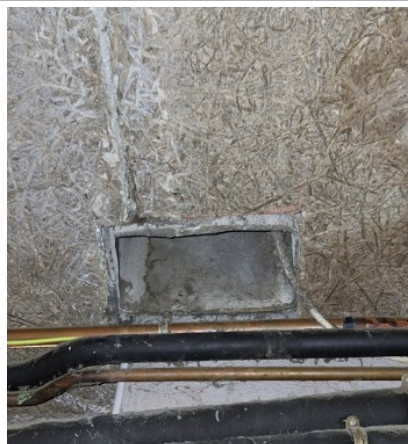
Prélèvement - P013 : RDC / Garage - Conduit- (Présence d'amiante)
